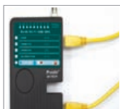
RJ45 Lan cable test
